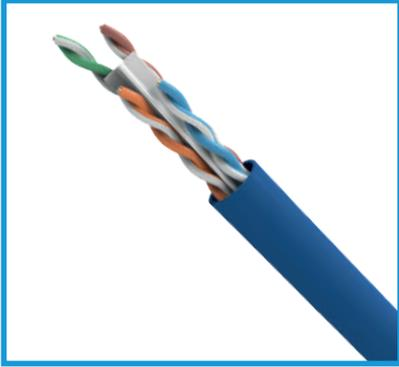
El cable sólido U/UTP SATRA Categoría 6 LSFRZH, de 4 pares trenzados, resistente a la propagación del fuego, baja emisión de gases tóxicos y bajo humo contaminante. Cumple con los requerimientos descritos en las especificaciones de la norma ANSI/TIA-568.2-D, brindando un ancho de banda (frecuencia de operación) de 250MHz y velocidad máxima de 1 Gigabit por segundo
